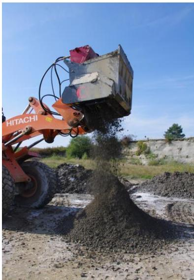
**Bild 10 – Schaufelseparator mit RSS Dosiereinheit zur Bodenaufbereitung**
