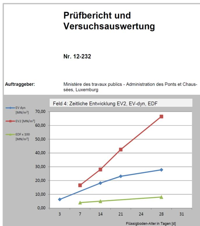
**Bild 4 - Korrelation zwischen verschiedenen Prüfverfahren (bodenart- und rezepturabhängig)**
