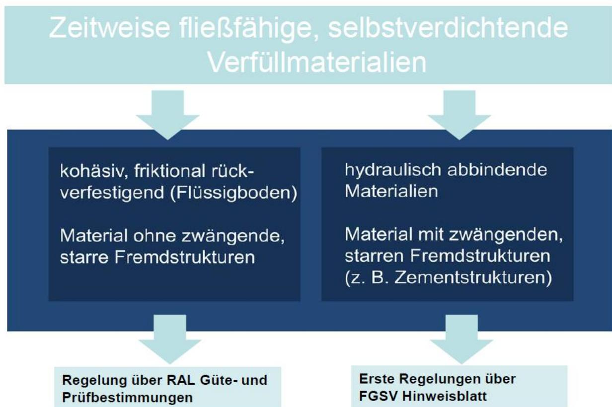
Bild 13 – Unterscheidung der ZFSV, von der Flüssigboden nur eine der 2 Untergruppen darstellt
