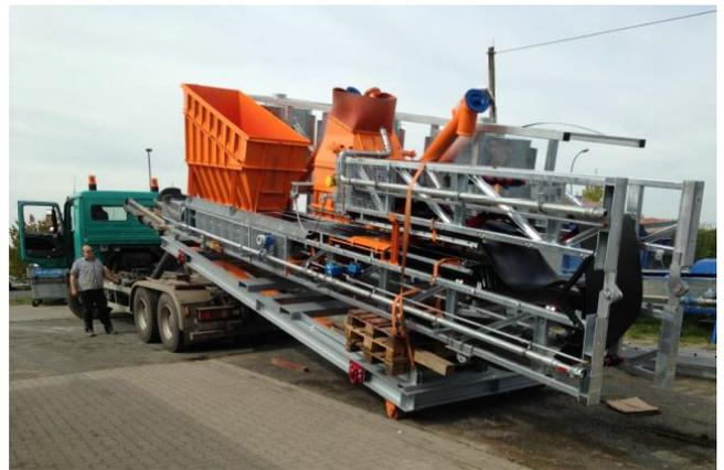
**Bild 9 - mobile Anlage mit Hakenlift**
